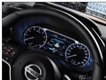
Улучшенный дисплей Advanced Drive Assist (ADAD) с диагональю 7,0" на панели инструментов
